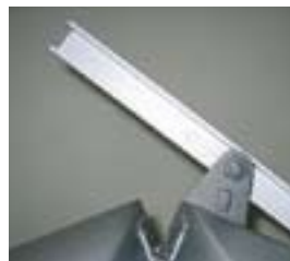
Das erste Flügelpaar wird geöffnet! Mittels Drehantrieb schwenken die Flügel in deren „offene“ Stellung!
